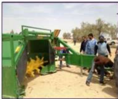
صورة ٥: ربط آلة التقليل بالجرّار الزراعي
